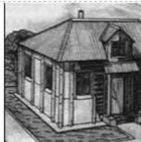
Облицовка дома плоскими листами шифера с утеплителем
