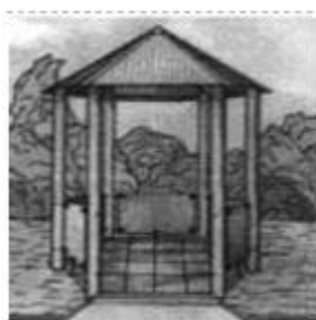
Садовые беседки из хризотилцементных труб и листов шифера
